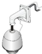
2. Schrauben Sie den Halterungsadapter (G1 1/2-Zoll-Gewinde) ein und sichern Sie ihn mit einer Schraube.
