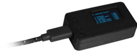
ALLNET 4duino IoT WLAN Display Gehäuse - ESP32 Modul mit 4 Zeilen Display
