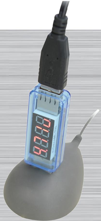
**Mit dem USB-PM1 lässt sich der Stromverbrauch angeschlossener USB-Geräte in Ampere und Volt messen und anzeigen.**
