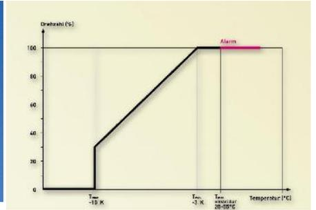
**CoolBlast Thermal Management Lüftereinheit, drehzahl geregelt, AC**
